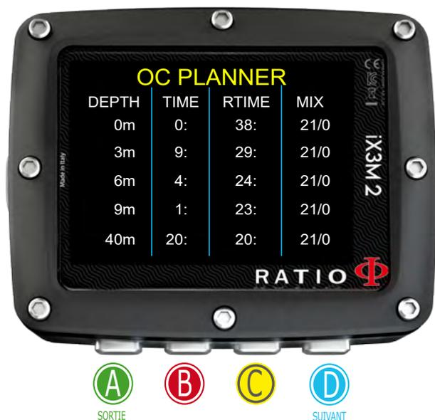
**ATTENTION :** le planificateur utilise 18 mt/min (60ft/min) comme vitesse de descente et 9 mt/min (30ft/min) comme vitesse de remontée pour les calculs de décompression. .
