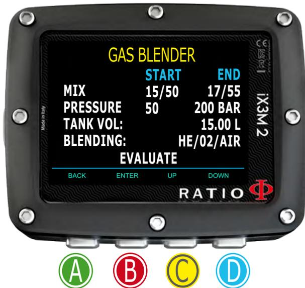
Après avoir appuyé sur **EVALUATE** si le mélange est possible avec les réglages insérés, l'iX3M 2 indiquera la procédure à suivre pour obtenir le mélange désiré.
