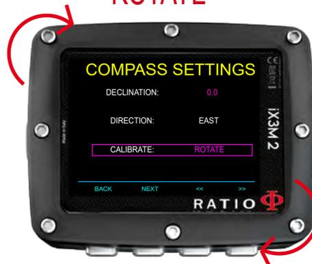
Tourner lentement et constamment l'appareil sur une surface plane.
