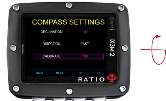
Tourner lentement et constamment l'appareil sur son axe vertical.
